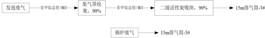
图 4.2-1 本项目废气处理系统图
